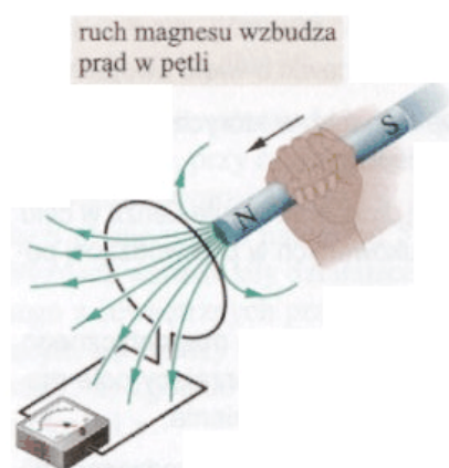
Rys. 28.1. Wzbudzanie prądu przez przesuwanie magnesu
