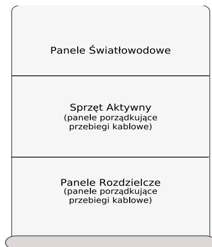
Rys. 2: Rozkład elementów w szafach punktów rozdzielczych.
